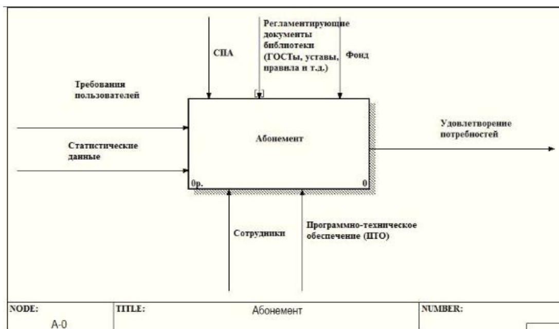
Рис. 1. SADT-модель нулевого (A0) уровня подсистемы «Абонент». Контекстная диаграмма
